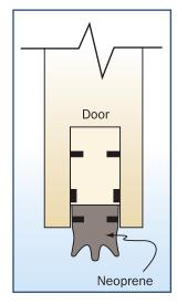
Figure 7 Automatic door bottom.
